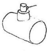
円柱面から探傷すると、糸でしか接触しないので、見かけ上探触子が小さくなるようになり、広がってしまう。
